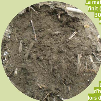
La matière sèche du produit finit (fraction inférieure à 30mm) est composée essentiellement de sable et de coquillages, d'une fraction fine du structurant et de la matière organique compostée des algues. Le produit est conservé en stabilisation sur le site pendant une durée d'un an afin de prévenir tout risque de présence d'hydrogène sulfuré (H<sub>2</sub>S) lors de son utilisation finale.
