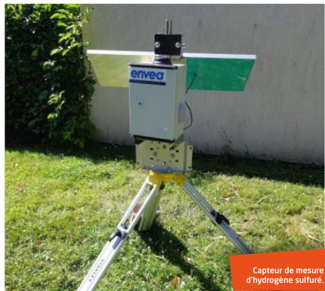
des habitations des riverains du site. Ils permettront un enregistrement en continu des concentrations en hydrogène sulfuré et donc une comparaison au seuil sanitaire défini sur 24h et au seuil de nuisances olfactives défini sur 30 minutes.
