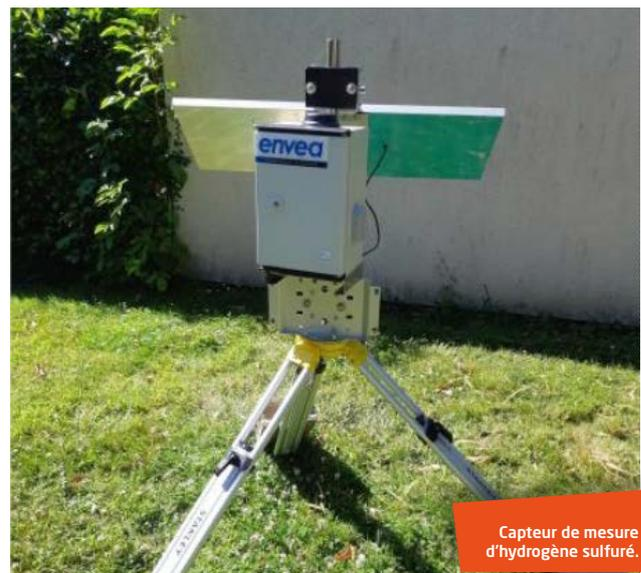
Capteur de mesure d'hydrogène sulfuré.
