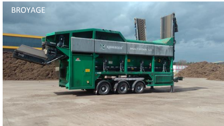
Criblage des déchets verts en 2 fractions
